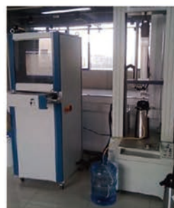
暖壶试验机上的电动缸
